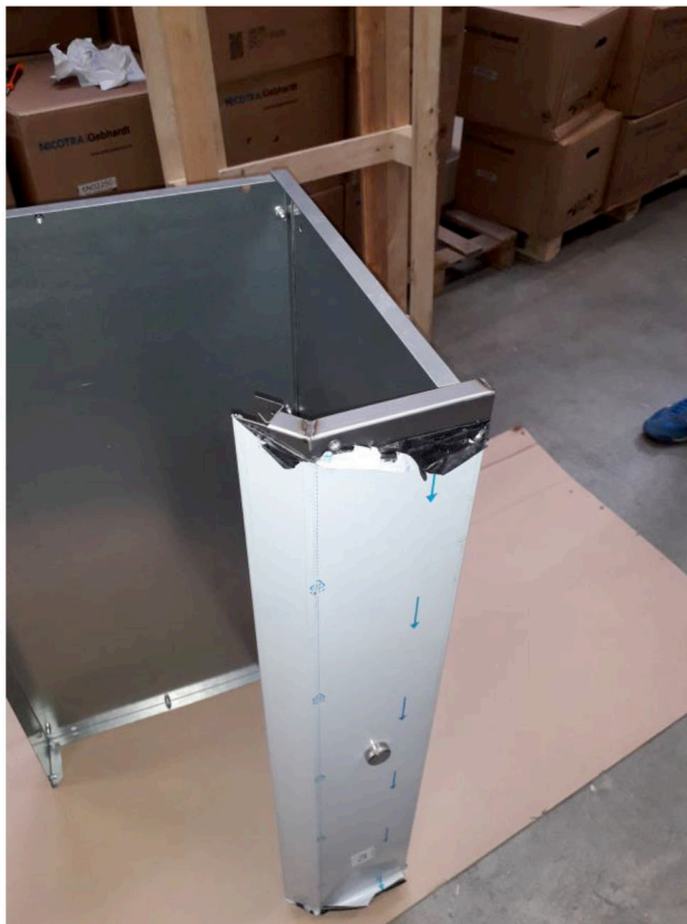
Visser le bac à graisse N°4 sur la tôle N°3
