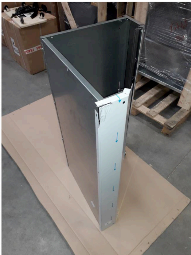
Placer la plaque 1a par-dessus le retour à 90° de la tôle 1b
